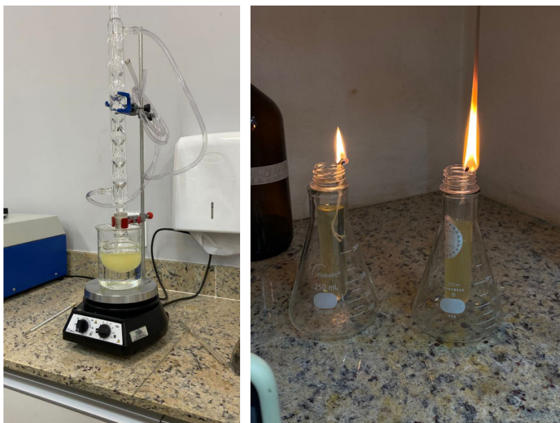
Figura 6. Síntese do biodiesel, sistema de refluxo. Confirmação do biodiesel ao comparar à chama de óleo.
