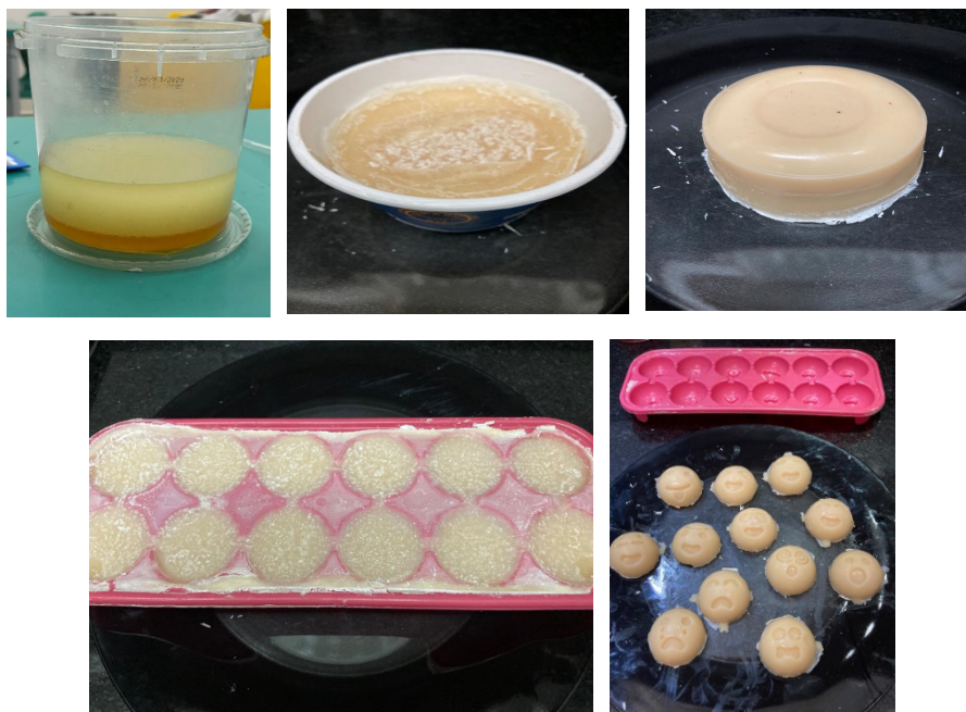
Figura 1. Mistura líquida em balde de plástico, seguido dos sabões em barra obtidos a quente.
