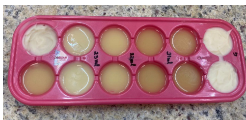
Figura 3. Otimização do fabrico de sabão em barra a frio, enformado em diferentes estados do processo.
