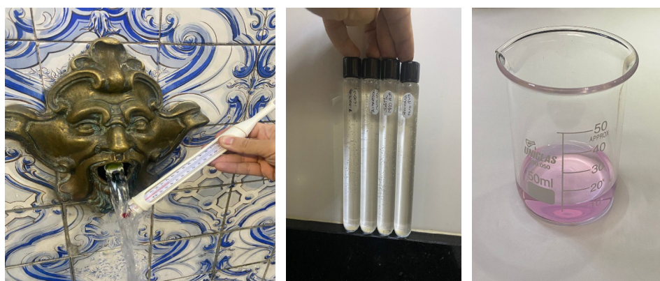
Figura 2. Medição de temperatura, amostras coletadas em frascos esterilizados e resultado padrão da titulação realizada com \text{NaHCO}_3 em presença de fenolftaleína.
