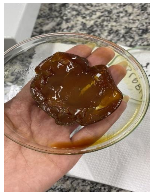
Figura 2: Celulose Bacteriana em processo de secagem após alcalinização.
