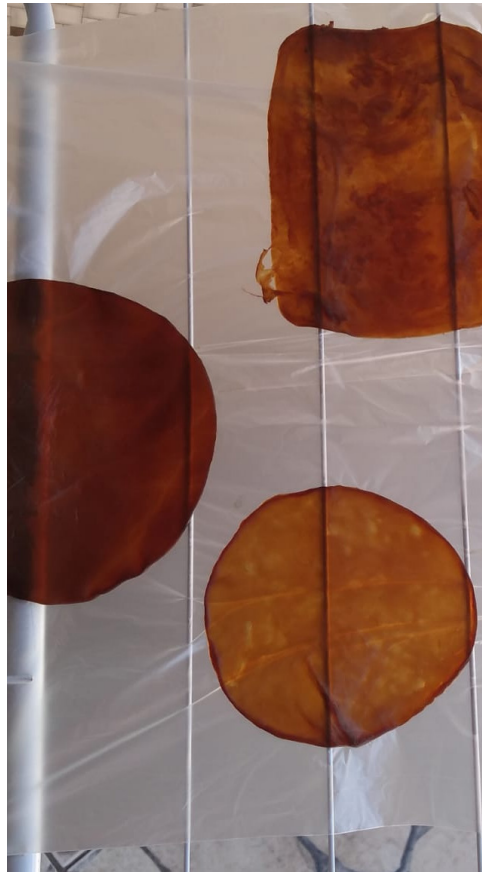
Figura 3: Celulose Purificada em hidrólise alcalina durante a secagem.
