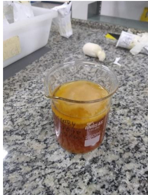
Figura 2: Celulose Bacteriana em processo de secagem após alcalinização.
