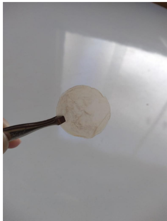
Figura 4: Celulose purificada em hidrólise e seca.
