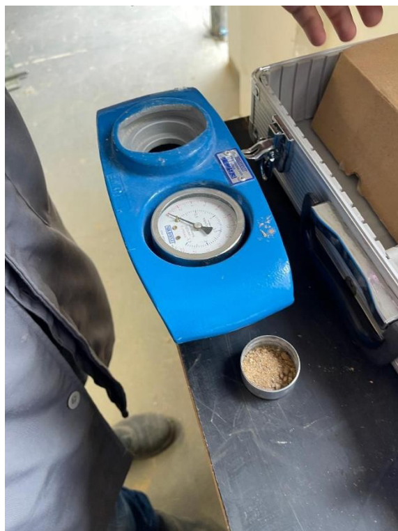
Fig. 4: Ensaio de Speedy Test . Ensaio de resistência a compressão axial
