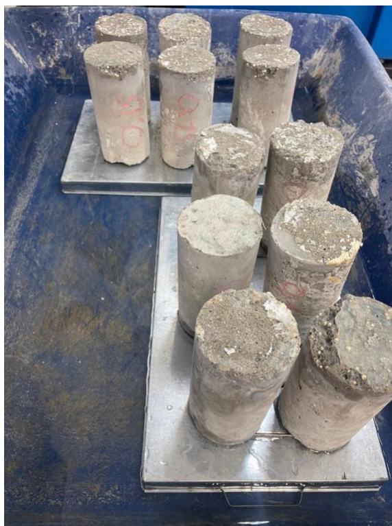
Fig. 7: Corpos de prova durante os ensaio de permeabilidade dos compósitos à base de concreto e flocos de isopor EPS.
