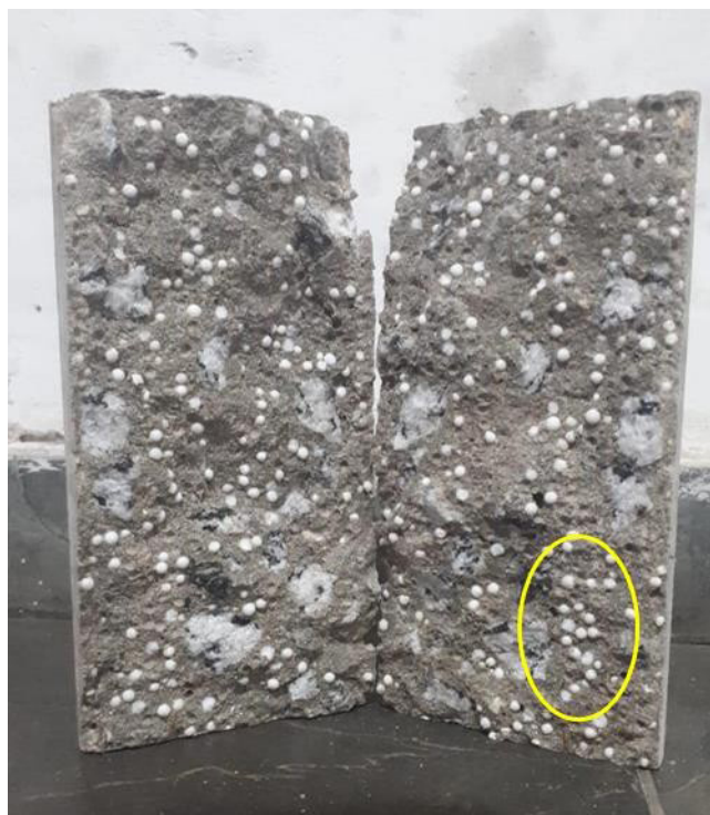
Fig. 6: Corpos de prova após os ensaios de resistência a compressão diametral dos compósitos EPS/concreto.
