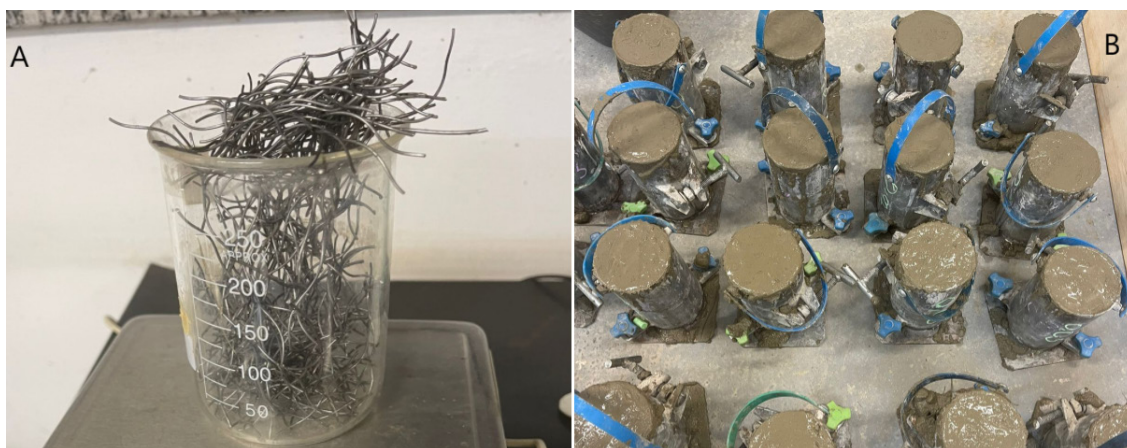
Fig. 3: (A) Pesagem das fibras de aço; (B) Preparo dos corpos de prova dos compósitos fibra de aço/concreto.
