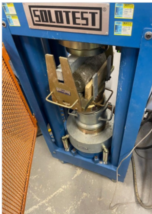
Fig. 6: Ensaio de resistência a compressão diametral.
