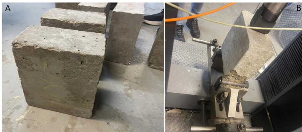
Fig. 10: Vigotas curadas e ensaio de resistência a flexão bi apoiada.
