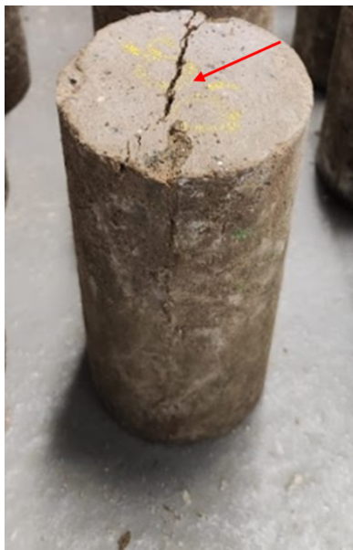
Fig. 8: Corpo de prova após ensaio de resistência a compressão axial.
