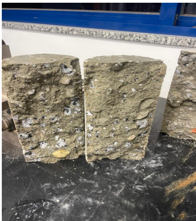
Fig. 13: Ensaio de carbonatação dos compósitos concreto/fibra de aço.
