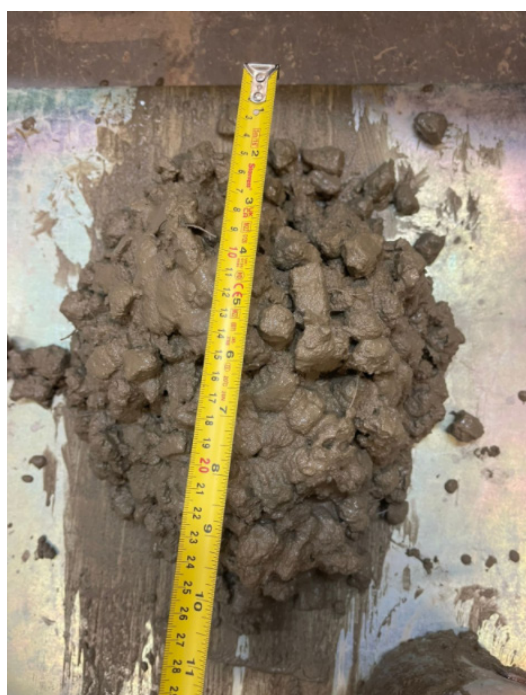
Fig. 4: Ensaio flow test do concreto.
