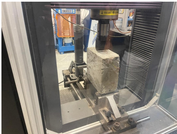
Fig. 7: Ensaio de flexão em vigotas.
