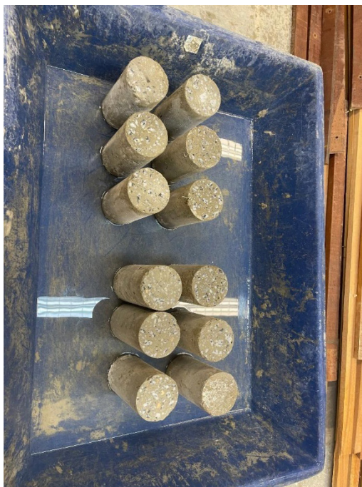
Fig. 12: Ensaio de permeabilidade dos compósitos concreto/fibra de aço.
