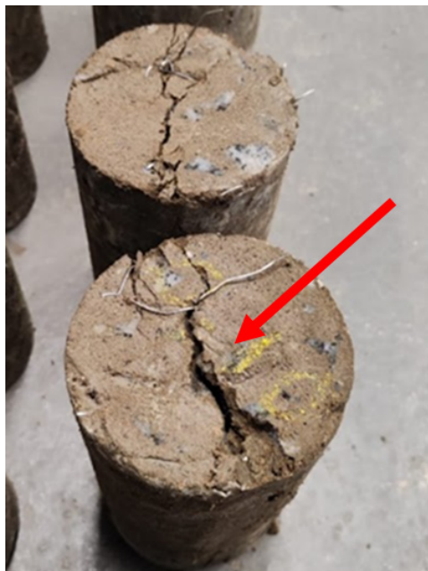
Fig. 9: Corpos de prova após os ensaios de resistência a compressão diametral.
