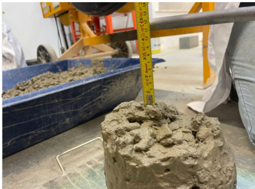
Fig. 3: Teste de abatimento de tronco de cone ( Slump Test ).
