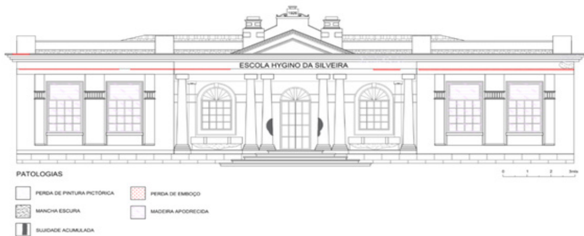
Figura 2 – Mapeamento de danos da fachada principal
