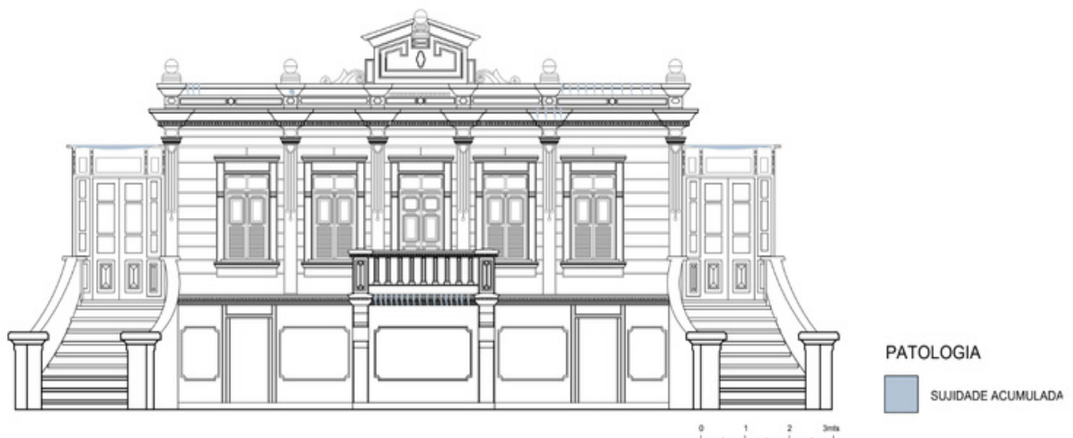
Figura 6 – Foto mapeamento de danos
