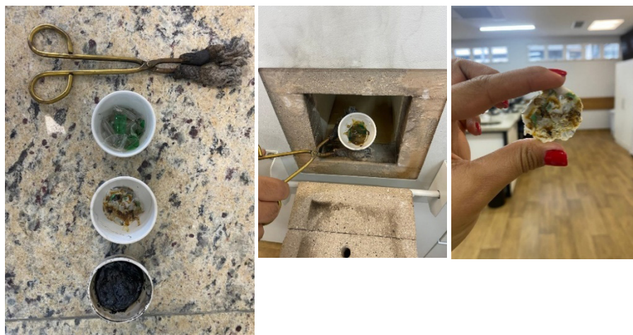
Figura 10. PET em diferentes condições antes e após ser levado à mufla (alto-forno) – antes durante e depois.
