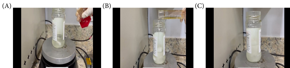
Figura 14. (A) Hidrólise alcalina do PET; (B) início da neutralização com ácido acético; (C) precipitação do ácido tereftálico em pH ácido.
