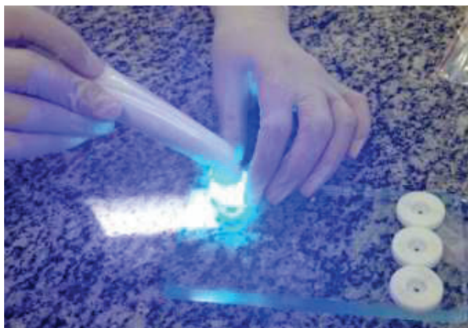
Figura 1 - a) Confeção dos blocos em Resina Composta.
