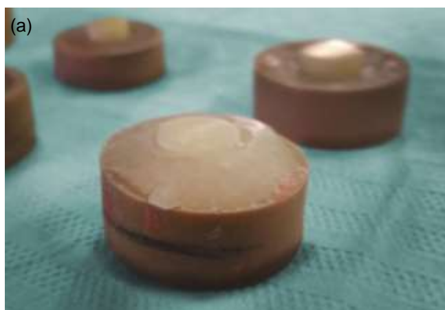
Figura 3 - a) Corpos de prova asperizados com lixa de carbeto de silício #600.
