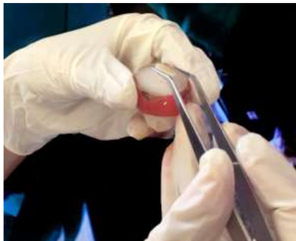
b) Inclusão dos blocos de Resina Composta na Resina Acrílica.
