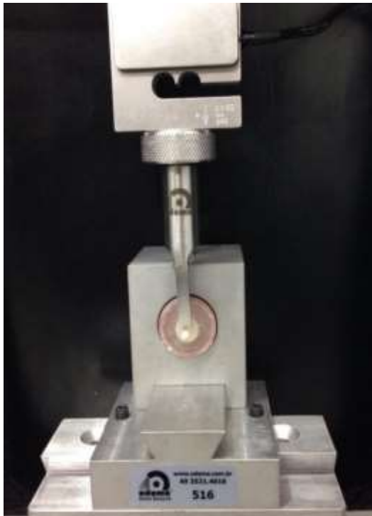
Figura 6: a) Corpo de prova posicionado na máquina de ensaios mecânicos.
