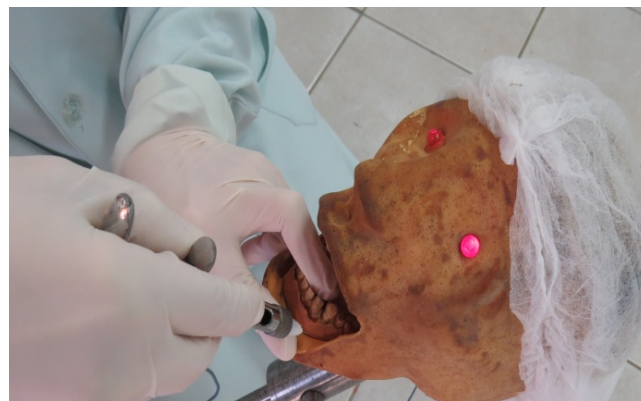
Figura 3: Manequim Craniofacial com sensores elétricos.
