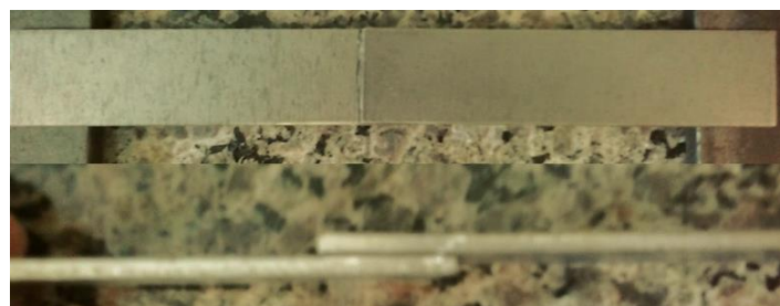
Figura 4: Modelo single lap utilizado para os ensaios de lap shear
