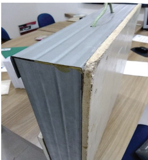
Figura 3 - Perfil com quatorze dobras usado nas obras da empresa Artcons
