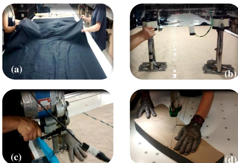
**Figura 4:** (a) Processo de enfesto, (b) Máquina de selar tecido, (c) Etapa de separação dos blocos, (d) Corte preciso na mesa insuflada
