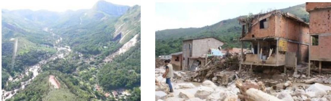
Figura 1: a) Vista geral em zig-zag da trajetória do fluxo de detritos no canal do córrego do Príncipe. b) Erosão do leito maior no Campo Grande, destacando-se a grande quantidade de blocos.
