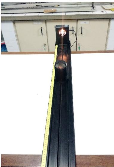
Figura 3 – Banco óptico com uma lente convergente.
