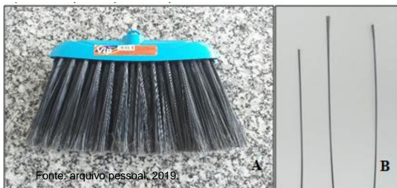
Figura 1 - Confeção dos swabs: A) Vassoura da qual foram obtidas as hastes; B) Hastes depois de passarem pelo Bico de Bunsen
