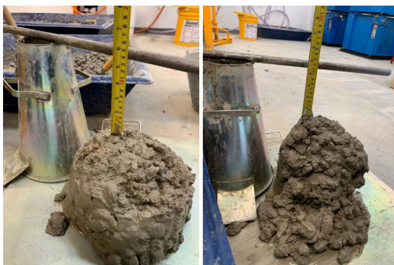
Figura 12: Slump test ; traço referência
