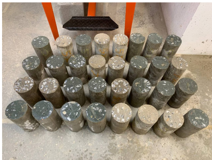
Figura 8: Máquina de retificação Figura 9: Corpos de prova retificados
